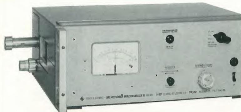
Strumento misuratore ad indicazione diretta del fattore di riflessione ZRZ
